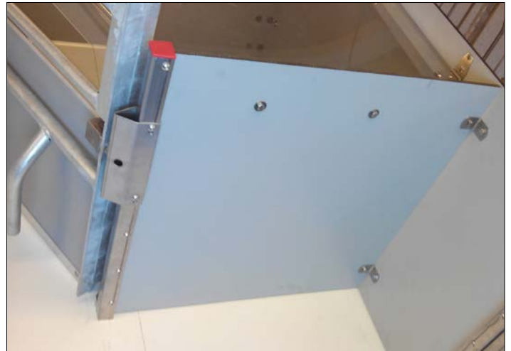
La paridera FT-30 puede ser fabricada en placas de fibra de 10 mm.
